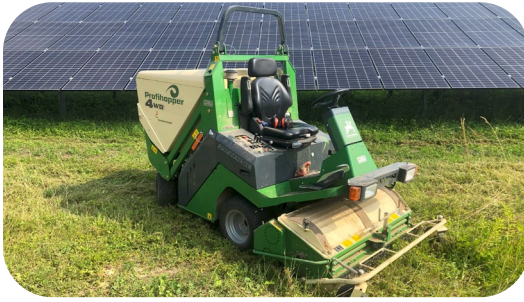
Mahd durch Schlägelmähwerk bei großen Flächen (direkte Mahdgutaufnahme) und Mahd mit Frontmähwerk eines Traktors bei sehr großen Flächen (Trommel-/Sichelmähwerk, nachträgliche Mahdgutaufnahme).
