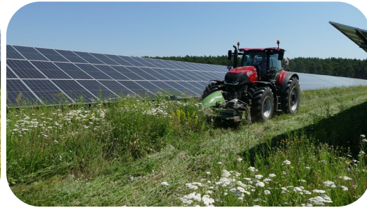
Mahd durch Schlägelmähwerk bei großen Flächen (direkte Mahdgutaufnahme) und Mahd mit Frontmähwerk eines Traktors bei sehr großen Flächen (Trommel-/Sichelmähwerk, nachträgliche Mahdgutaufnahme).
